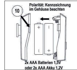
Zum Wechseln der Batterien hebeln Sie das Gehäuse mit einer Geldmünze auf. Bitte achten Sie auf die richtige Polung der Batterien.
